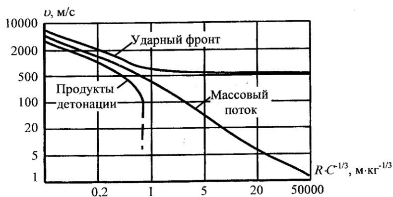
Рисунок 45. Зависимость скоростей ударного фронта, массового потока и фронта продуктов детонации от приведенного расстояния при взрыве заряда тротила в воздухе
