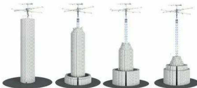
Рисунок 2 - 3D модель гравитационных батарей
